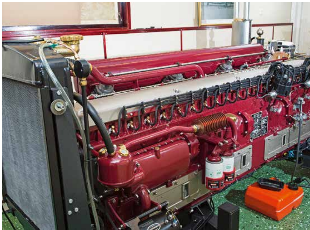
STORVERKET. Herkules 1934 bakom sin kylare från Scania-Vabis. Det krävs ett tränat öga för att upptäcka de fyra renkapade Volvo B20-blocken som sammanfogats med snyggt skulpterade mellandelar och det stora gemensamma vevhuset.
