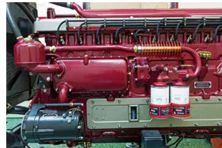
HÖJDARE. Motorn är avsevärt högre än en B20 tack vare det kraftiga gemensamma vevhuset i botten. Kylaren på oljereturrlöret är gjord av en gammal kopparsplåt som blev över på ett jobb i Munkfors på 70-talet.
