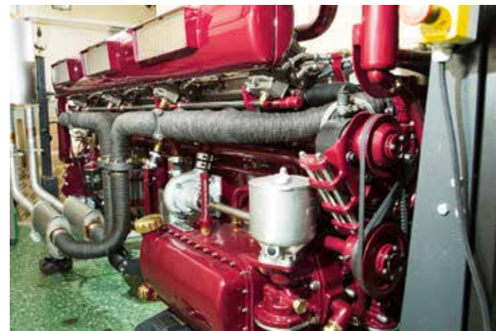
BJÄSSE. Motorns dimensioner för tankarna mer mot fartygsmotorer än Volvo B20, det är en imponerande pjäs. Mitt i bilden syns vattenpumpen med sin drivaxel. Bakom den långa luftburken med tre filterinsatser finns fyra Stromberg-karburatorer.
