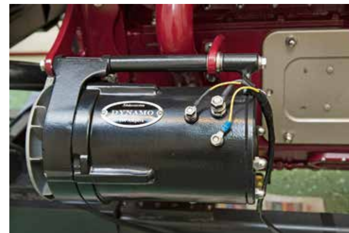
KOSMETIK. Likströmgenerator på 100 ampere? Var hittar man en sådan? Pelle köpte en Biltema växelströmgenerator och gav den ett förlängt hölje med ventilationsgaller på motorsidan och en svarvad bakre gavel.
