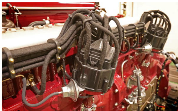
Hela motorn har 1930-talsutseende. Därför har Pelle Söderström lindat kablarna med tygtejp för att de ska få tidstypiskt utseende.
