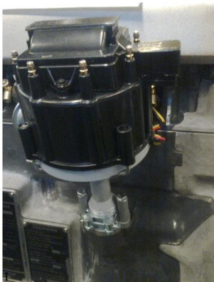
I bild visas den främre av de två HEI-fördelarna.
