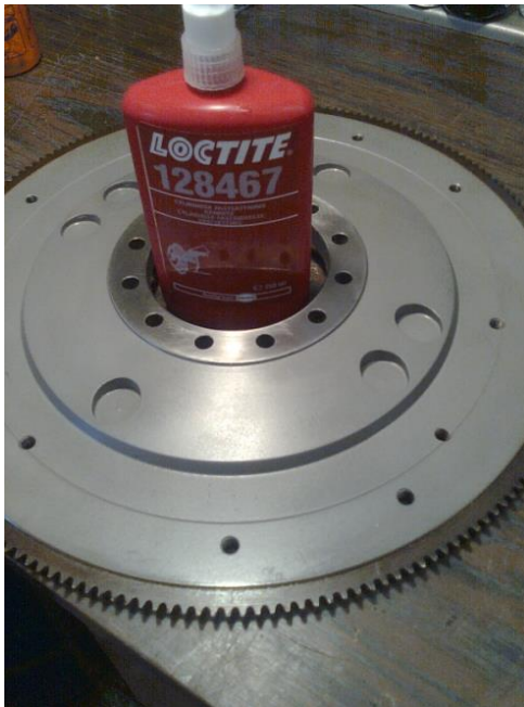
Svänghjulets startkrans limmad med Loctite
