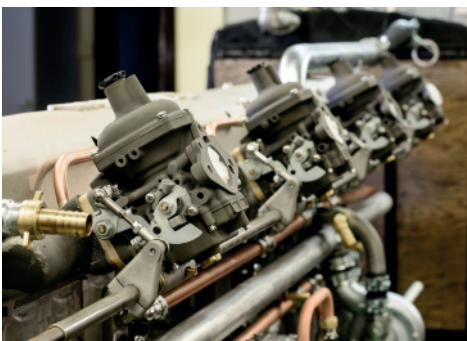
► Fyra Strombergförgasare, renoverade in i minsta detalj, matar fyra cylindrar vardera.
