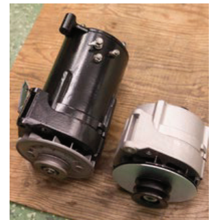
Att motorn i slutändan blir en fröjd för ögat såväl som örat är viktigt för Pelle. Det som ser ut som en likströmsgenerator (till vänster) är i själva verket en modifierad växelströmsgenerator (till höger i bild).
