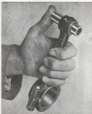
Bild 36. Kolv tappens passning
