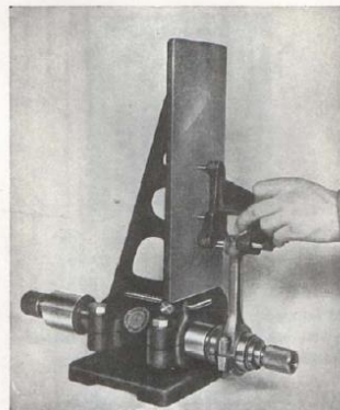
Bild 37. Kontroll av vevstake
